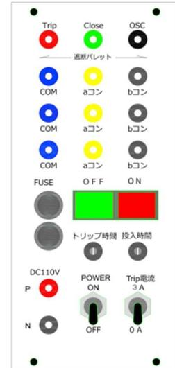
保護継電器の動作試験において、高圧遮断器 (CB) の代わりに接続します。トリップやクローズの動作試験を効率よく行うための模擬遮断器です。
